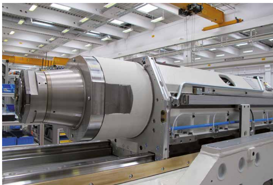
Figura 5: sistema di misura lineare HEIDENHAIN in un centro di lavoro orizzontale (foto: GROB-WERKE GmbH & Co. KG)
